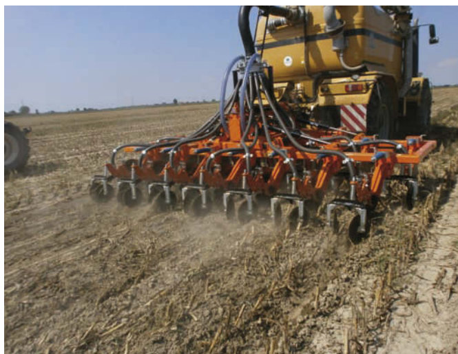
■ L’Idl è stato progettato per iniettare il liquame a una profondità massima di 15 cm.
